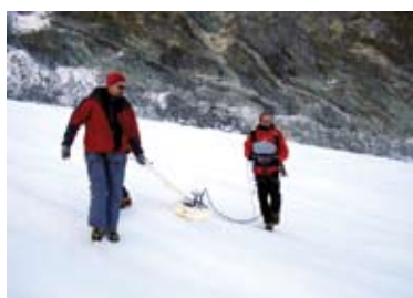
Fasi di acquisizione dati di spessore del manto nevoso con tecnica GPR.
